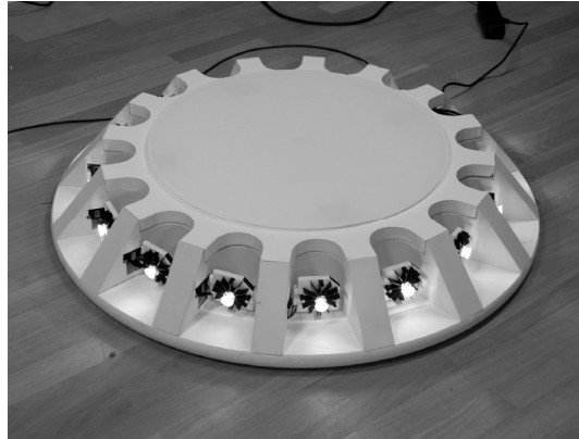
Abbildung 1: Hardware Maskenrad, Trittfläche und bewegbare RGB LEDs
